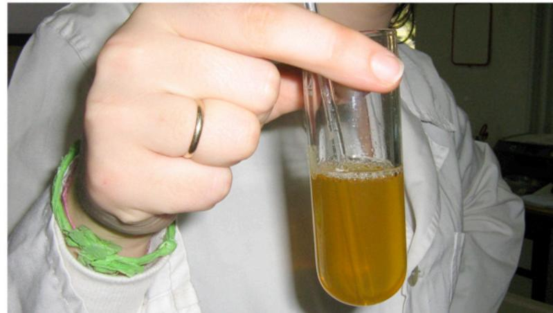
centrifugare per 10 min a 2800 rpm
