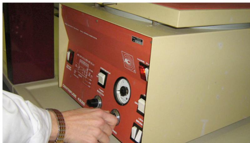
eliminare il surnatante e mantenere il sedimento, poi ridiluire con 10 mL di acqua distillata e centrifugare per 5 min a 2800 rpm
